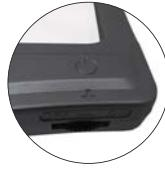
持ち手部のダイヤルを回転させて明るさを調節
